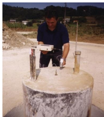
Slika 41. Ručno računalo za akviziciju podataka, te prikaz postupka ispitivanja
