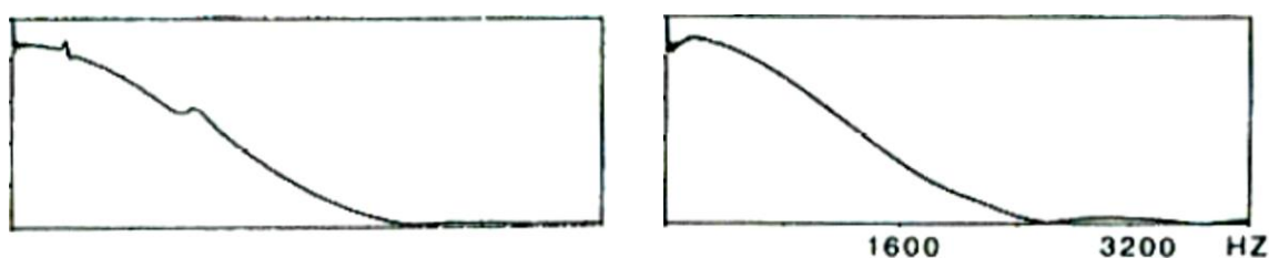
Slika 42. a) Frekventni spektar "normalnog" čekića, b) Frekventni spektar nakon podešavanja ručke čekića
