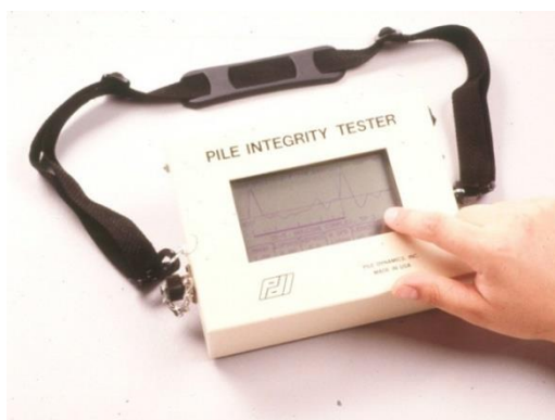
Slika 41. Ručno računalo za akviziciju podataka, te prikaz postupka ispitivanja
